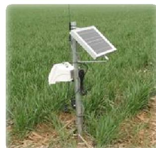
**Boîtier Alimentation (Batterie 12V) + Modem
